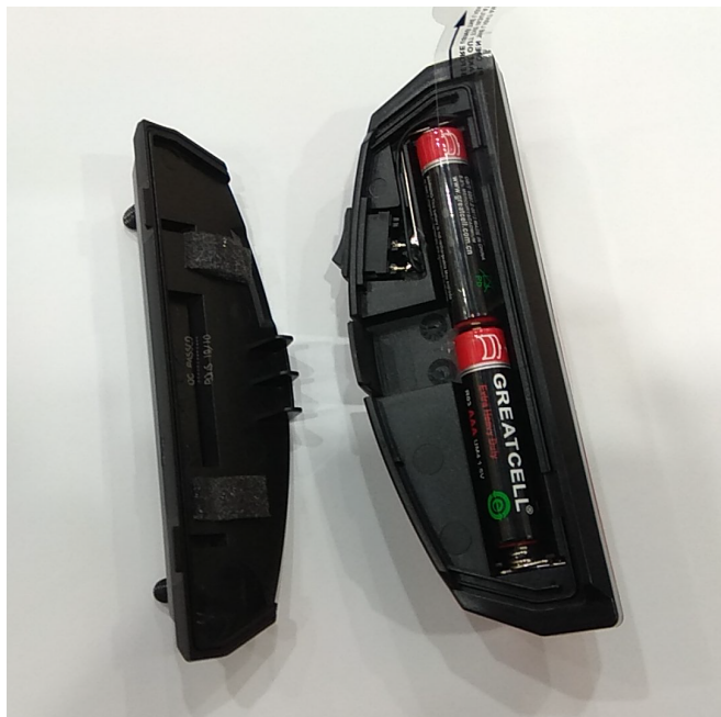
1) Ouvrir le boîtier du feu arrière
