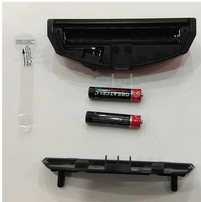
2) Enlever les piles et le plastique de protection.
